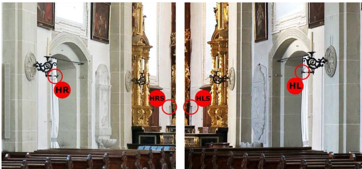
Abb. 4: Mikrofonierung Seitenschiffe mit Gross-AB Systemen in der Hofkirche Luzern, CH
