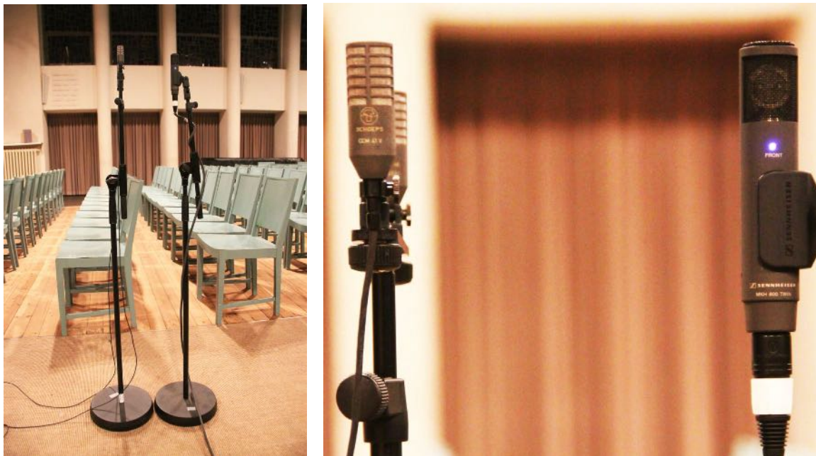
Abb. 6a und 6b: Versuchsanordnung Supernieren Schoeps CCM-41V und Sennheiser MKH 800 TWIN in der Jesus-Christus-Kirche Berlin-Dahlem
